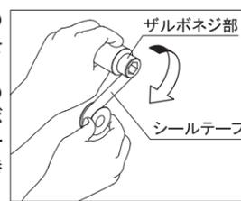
③ザルボを壁の中にねじ込み、「六角レンチ」で締付けます。
