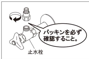
②ジョイント金具にパッキンが付いているのを確認してから、止水栓に「レンチ」などでしっかりと締付けます。
