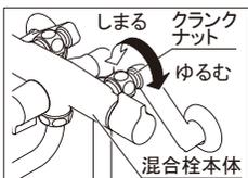
「レンチ」などでクランクナットをゆるめて、混合栓本体とクランクパッキンをクランクから取外します。
